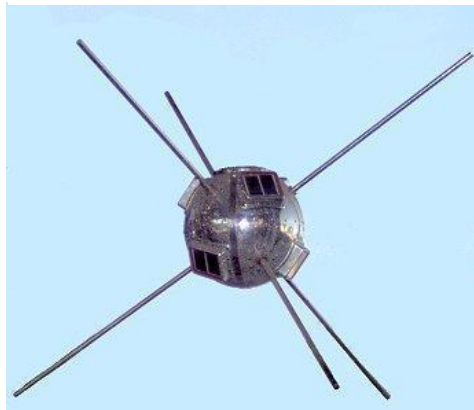
Figura 4 - Células a silício em satélites.
