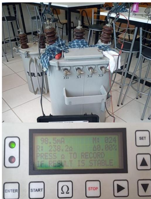
Figura 51 - Ensaio entre as buchas de ALTA (H1/H3) – Posição de TAP 0/3
