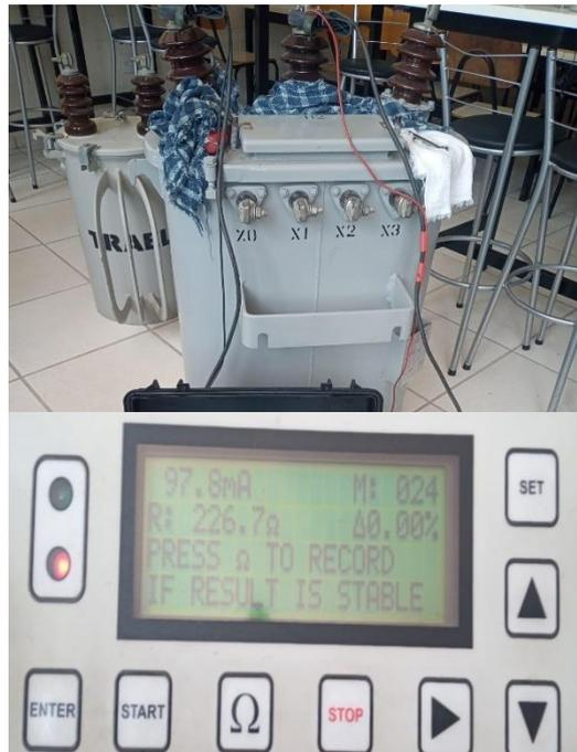
Figura 53 - Ensaio entre as buchas de ALTA (H1/H2) – Posição de TAP 0/4
