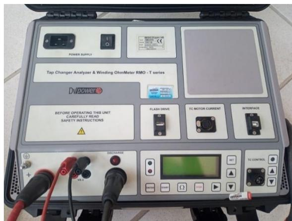
Figura 42 - equipamento utilizado para Ensaio de Resistência Ôhmica Utilizando - RMO-TD
