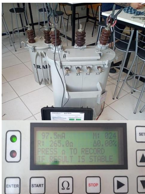
Figura 45 - Ensaio entre as buchas de ALTA (H1/H3) – Posição de TAP 0/1
