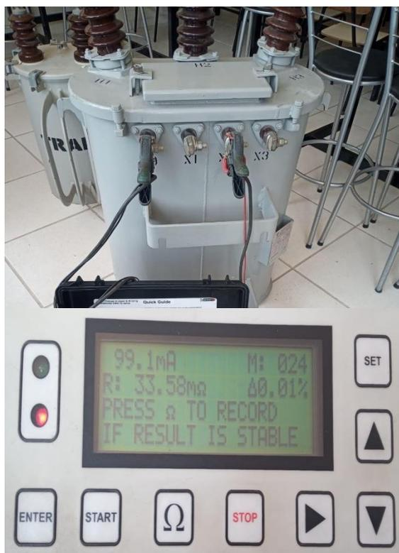
Figura 57 - Ensaio entre as buchas de BAIXA (X0/X2) – Posição de TAP 0/1
