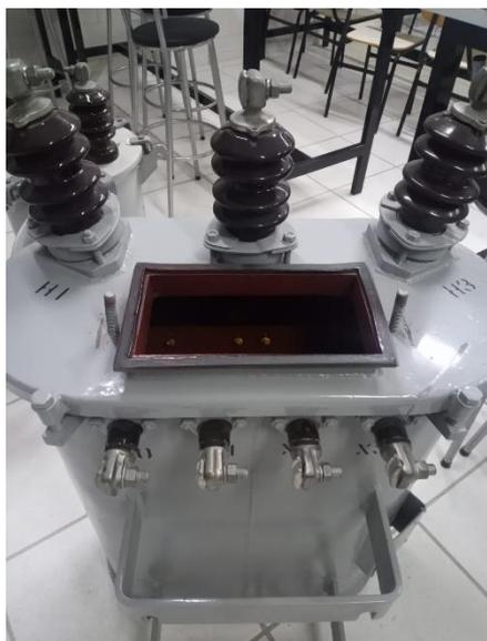
Figura 20 - Tampa de compartimento do transformador
