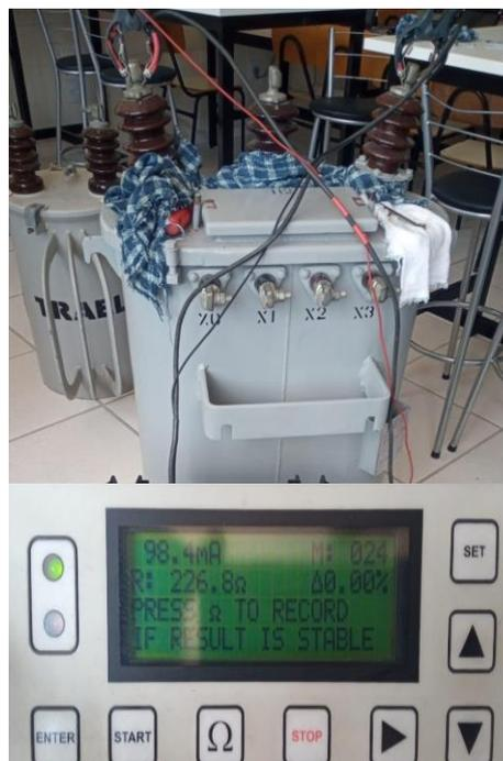
Figura 54 - Ensaio entre as buchas de ALTA (H1/H3) – Posição de TAP 0/4
