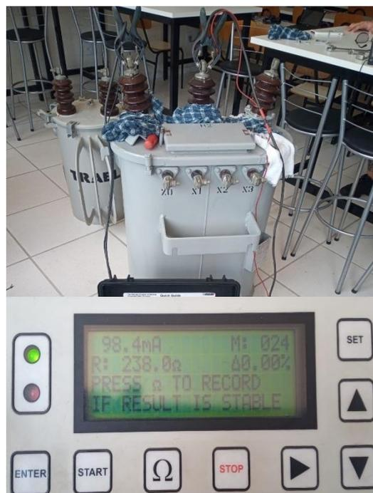
Figura 50 - Ensaio entre as buchas de ALTA (H1/H2) – Posição de TAP 0/3
