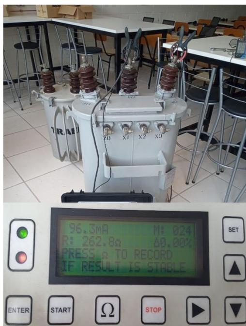
Figura 46 - Ensaio entre as buchas de ALTA (H2/H3) – Posição de TAP 0/1
