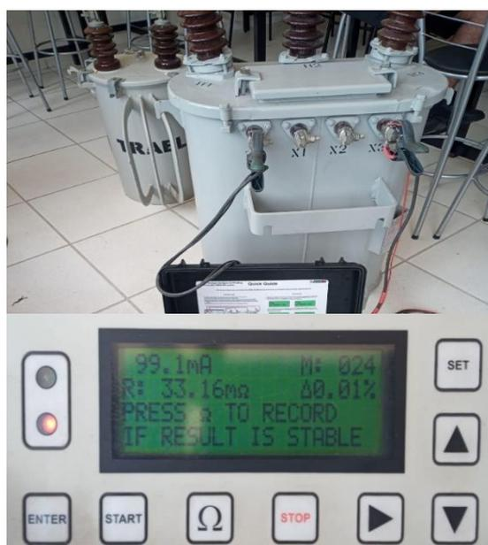
Figura 58 - Ensaio entre as buchas de BAIXA (X0/X3) – Posição de TAP 0/1
