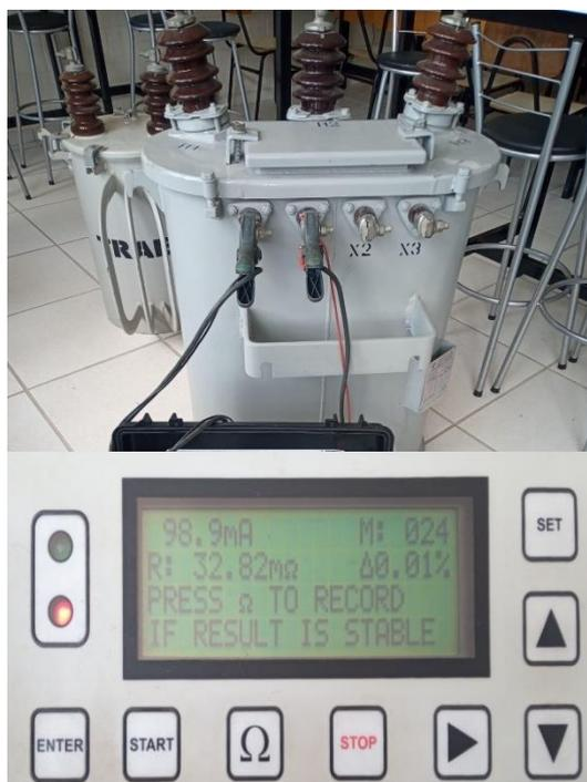
Figura 56 - Ensaio entre as buchas de BAIXA (X0/X1) – Posição de TAP 0/1
