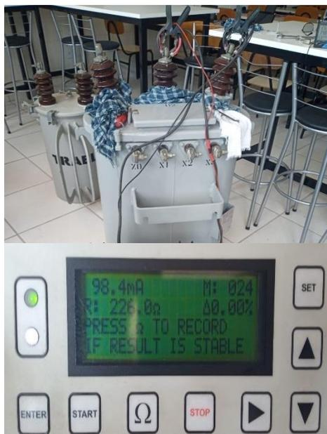
Figura 55 - Ensaio entre as buchas de ALTA (H2/H3) – Posição de TAP 0/4
