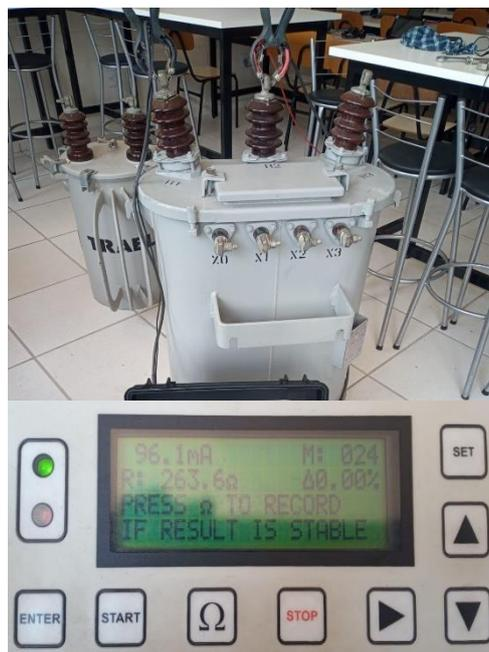
Figura 44 - Ensaio entre as buchas de ALTA (H1/H2) – Posição de TAP 0/1
