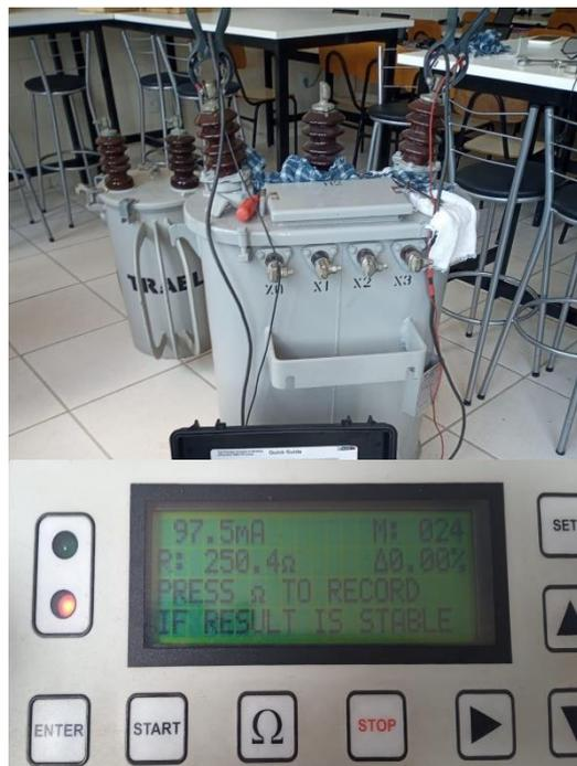
Figura 48 - Ensaio entre as buchas de ALTA (H1/H3) – Posição de TAP 0/2
