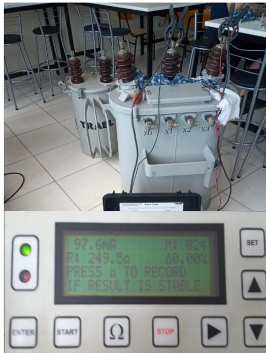
Figura 49 - Ensaio entre as buchas de ALTA (H2/H3) – Posição de TAP 0/2
