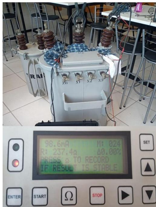
Figura 52 - Ensaio entre as buchas de ALTA (H2/H3) – Posição de TAP 0/3
