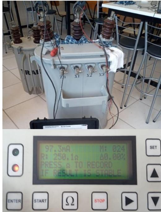
Figura 47 - Ensaio entre as buchas de ALTA (H1/H2) – Posição de TAP 0/2
