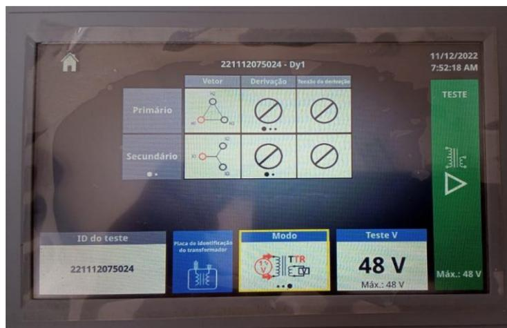
Figura 28 - Configuração de ligação MEGGER TTRU3
