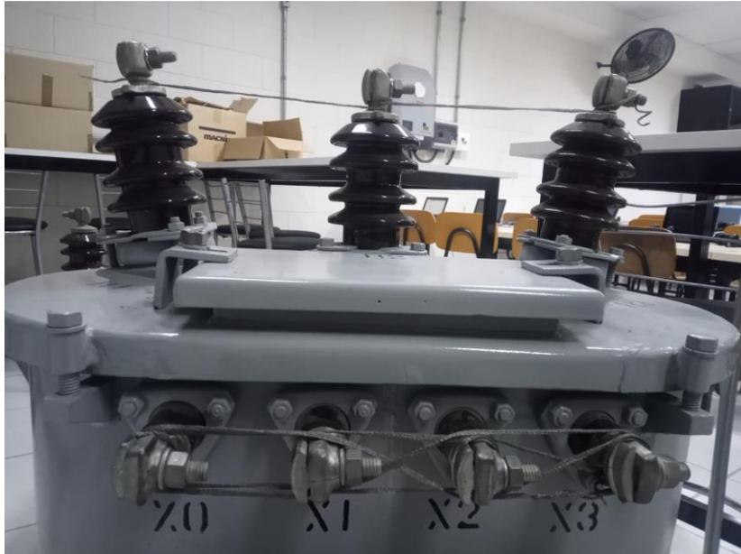
Figura 61 - Conexões de baixa curto-circuitada
