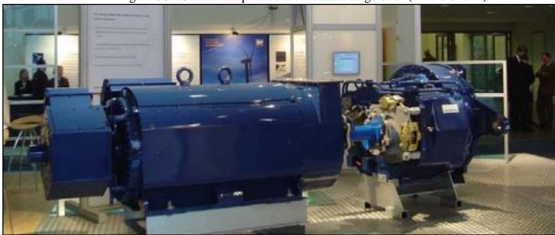
Figura 58 - Caixa multiplicadora conectada ao gerador (vista à direita)
