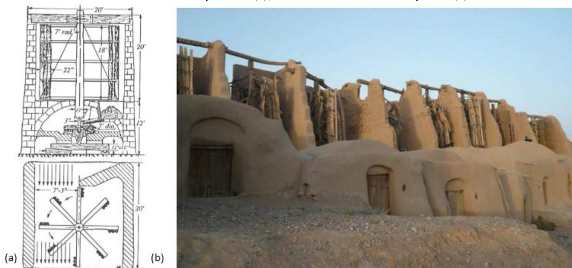
Figura 9 - Moinho de vento persa na cidade de Neh. A pedra do moinho está abaixo do rotor e as velas estão fixadas nas palhetas (a), vista frontal dos moinhos persas (b)
