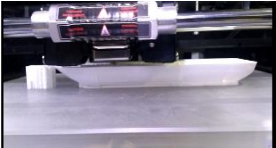
Figura 32 - Garrafa PET sendo impressa na impressora 3D
