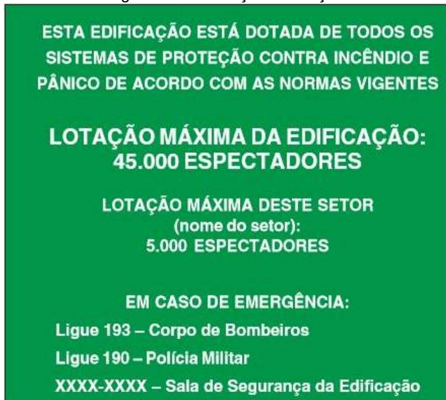
Figura 57: Sinalização de lotação.
