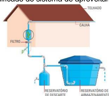
Figura 5: Esquema simplificado do sistema de aproveitamento de água pluvial
