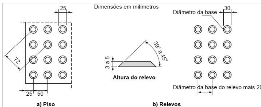
Figura 71: Sinalização tátil de alerta e relevos táteis de alerta instalados no piso.
