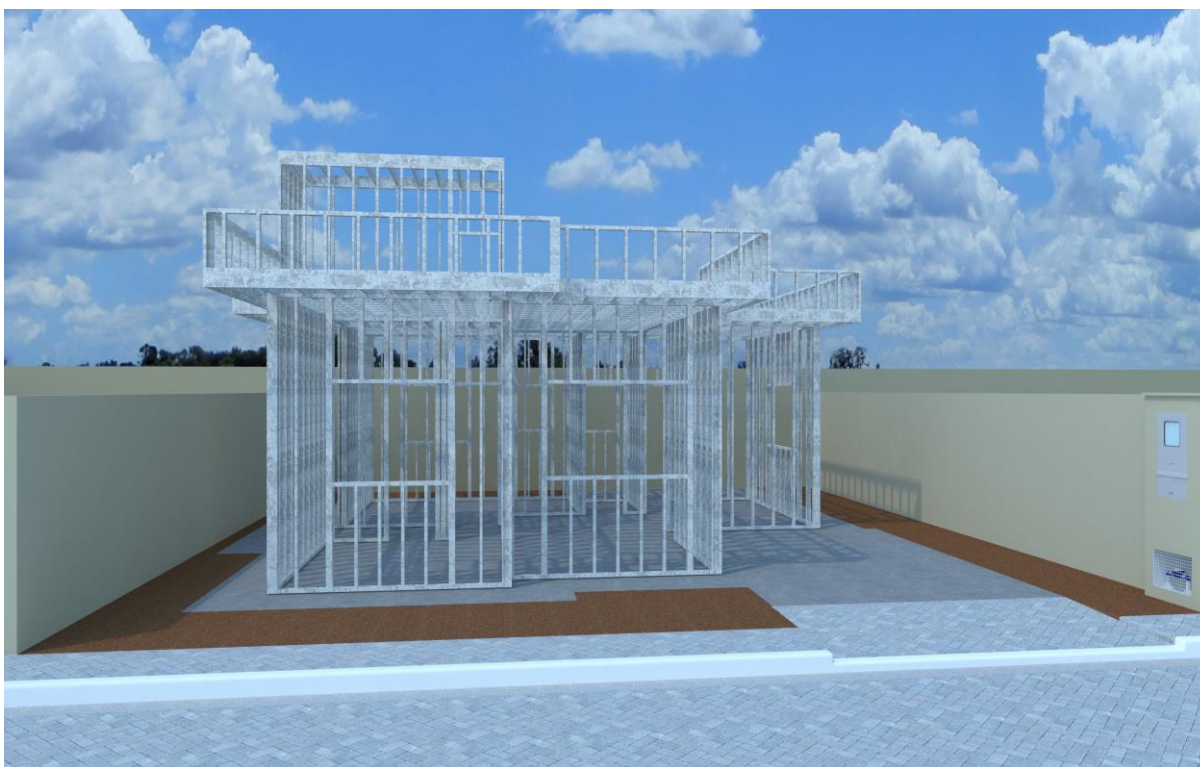
Figura 42: Estrutural em Steel Framing.
