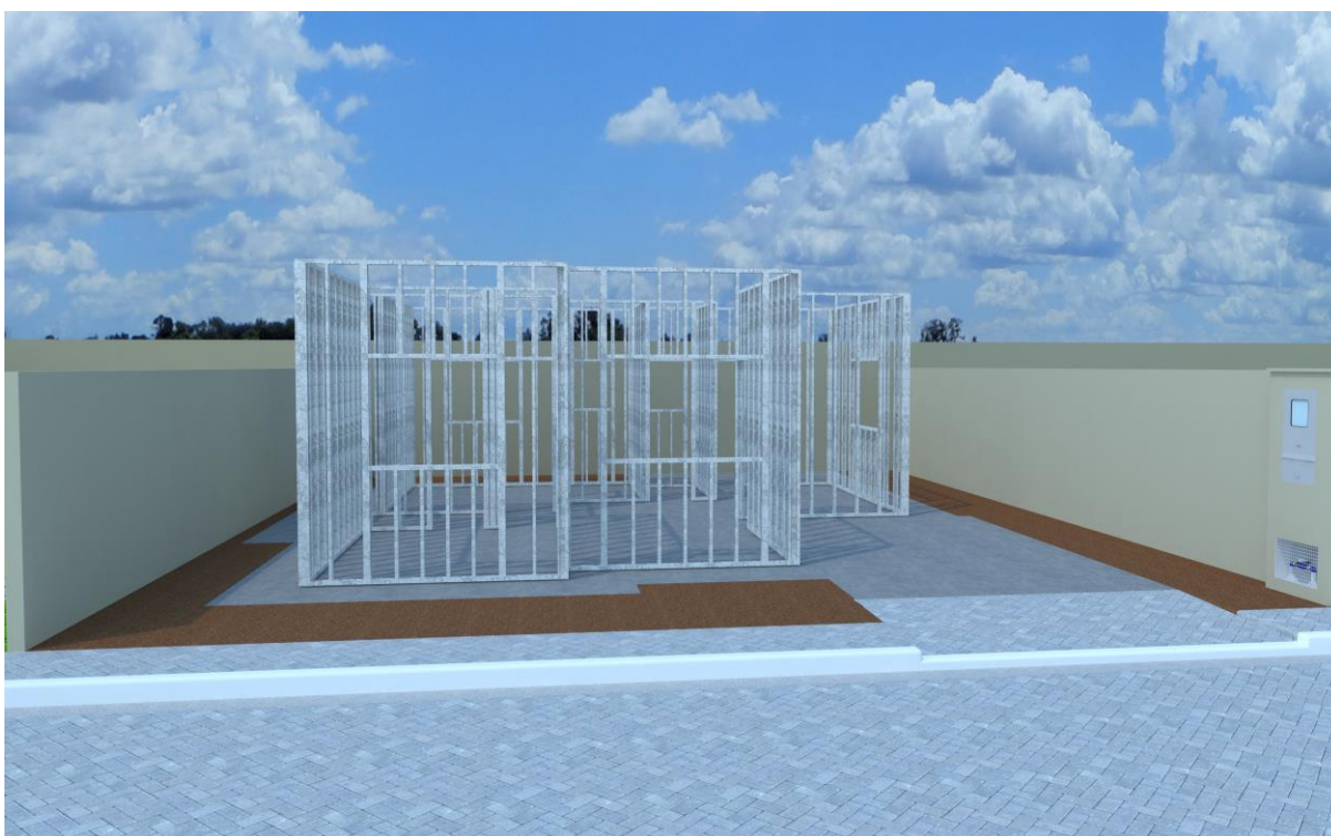
Figura 41: Estrutural em Steel Framing.
