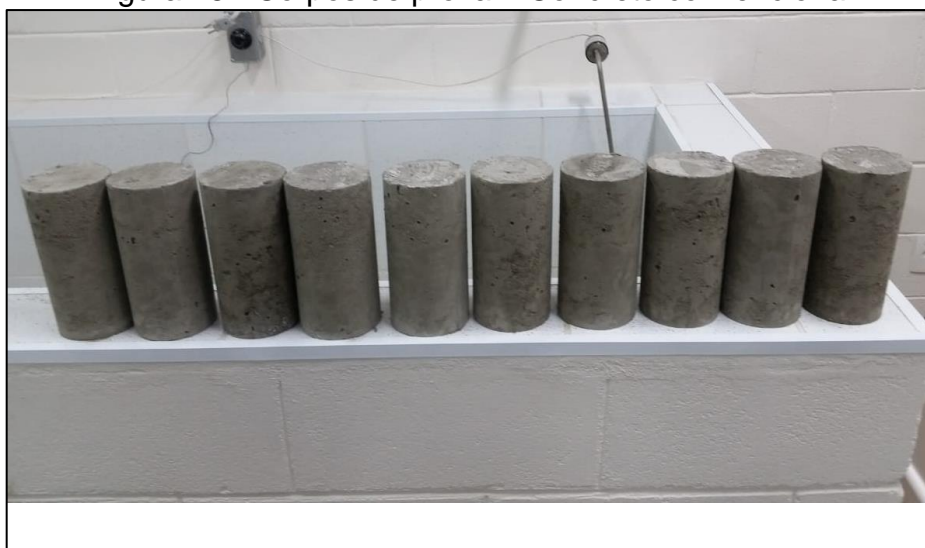
Figura 18 - Corpos de prova – Concreto convencional
