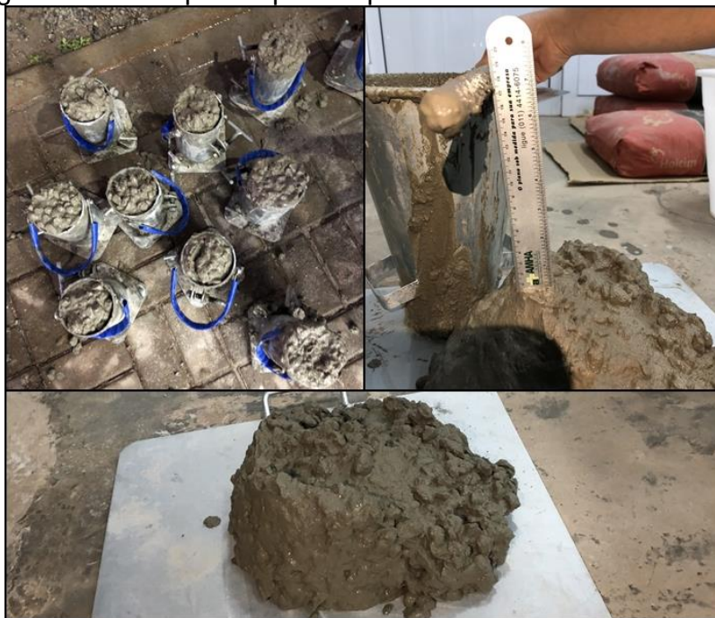
Figura 21 - Slump e corpos de prova - Concreto convencional
