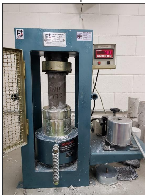
Figura 6 - Teste de compressão do concreto
