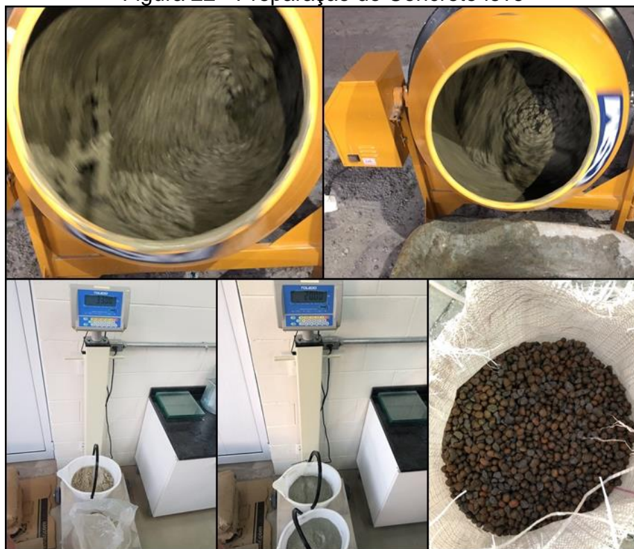
Figura 22 - Preparação do Concreto leve
