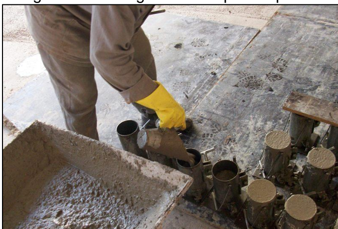
Figura 1 - Moldagem dos corpos de prova
