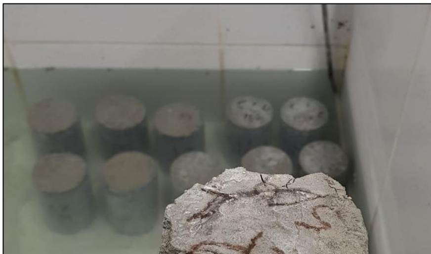
Figura 16 – Cura úmida do concreto
