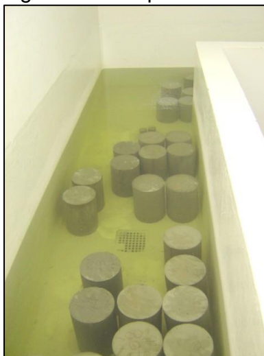
Figura 5 - Tanque de cura
