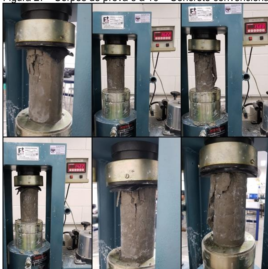
Figura 27 - Corpos de prova 6 a 10 – Concreto convencional
