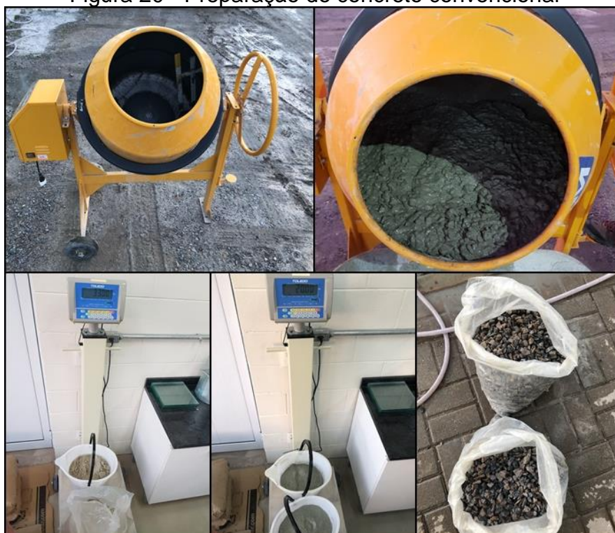
Figura 20 - Preparação do concreto convencional
