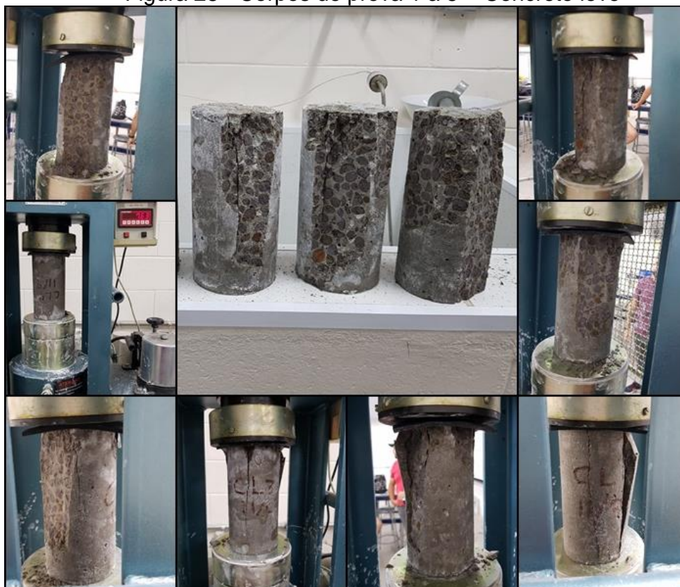
Figura 28 - Corpos de prova 1 a 5 – Concreto leve
