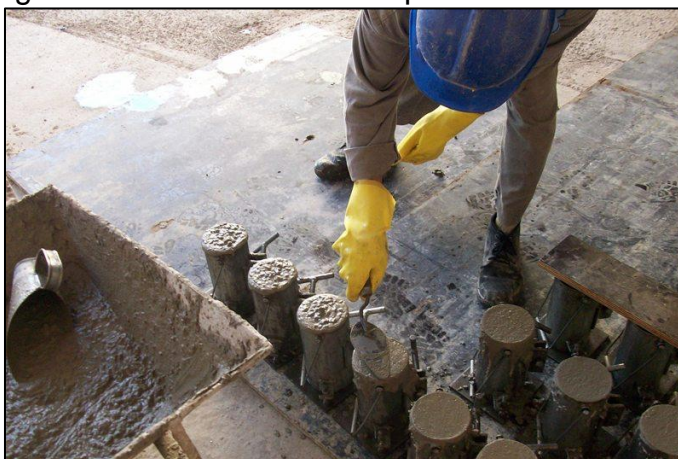
Figura 2 - Arrasamento da superfície de concreto
