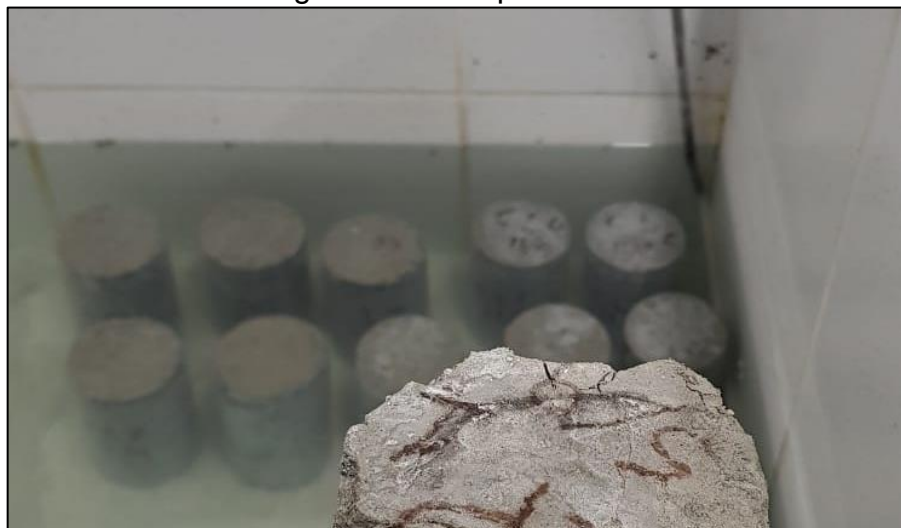
Figura 24 - Tanque de cura
