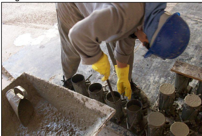
Figura 3 - Adensamento com haste metálica
