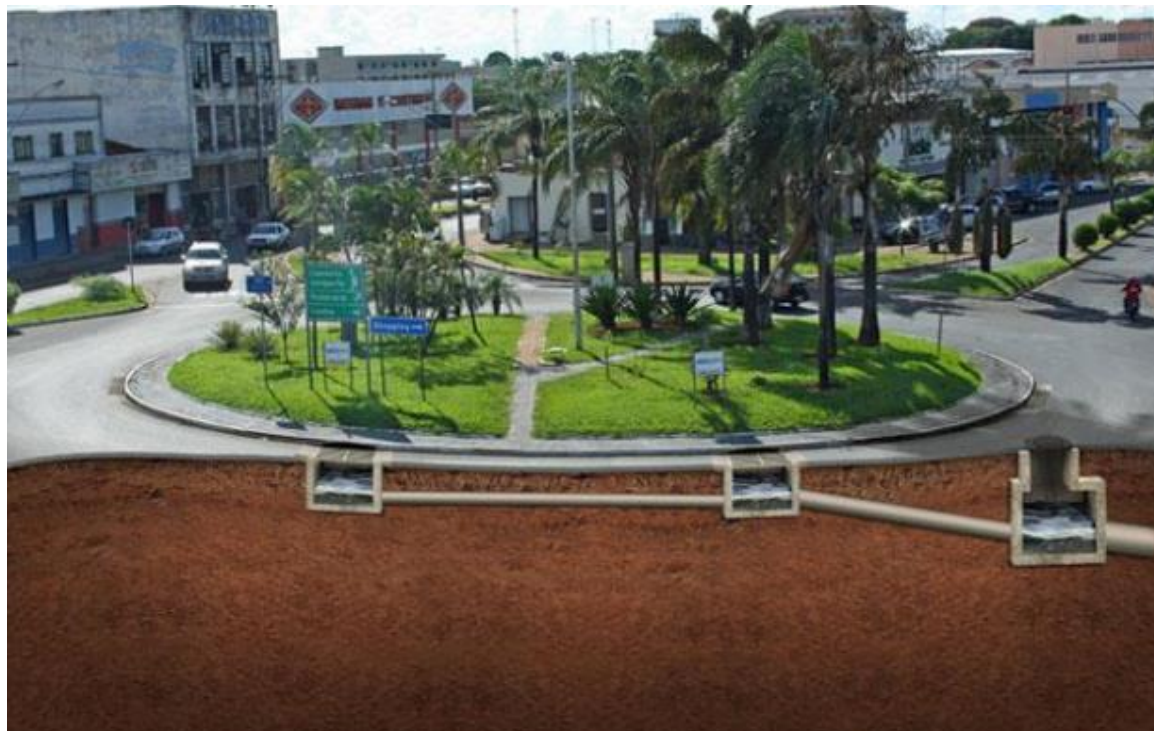
Figura 21 - Corte do sistema de micro drenagem
